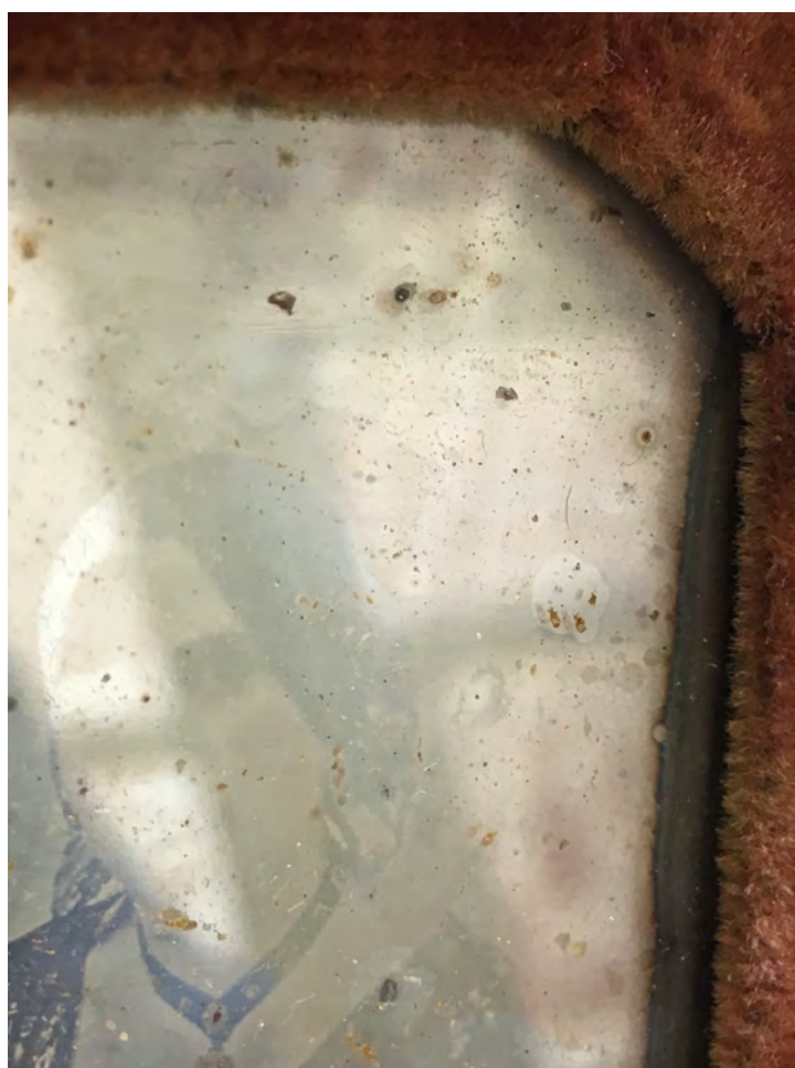
2. kép Üvegkorrózió és enyvdarabák a lemez felületén.
